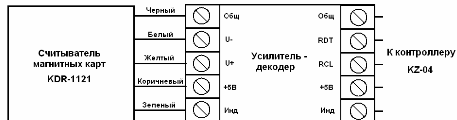
Рис.3 Схема подключения устройства чтения МК KZ-1121
