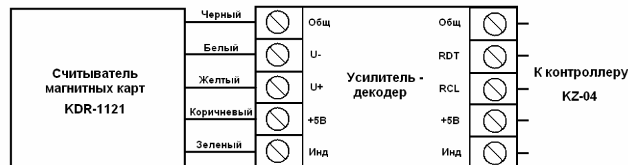
Рис.3 Схема подключения устройства чтения МК KZ-1121-M
